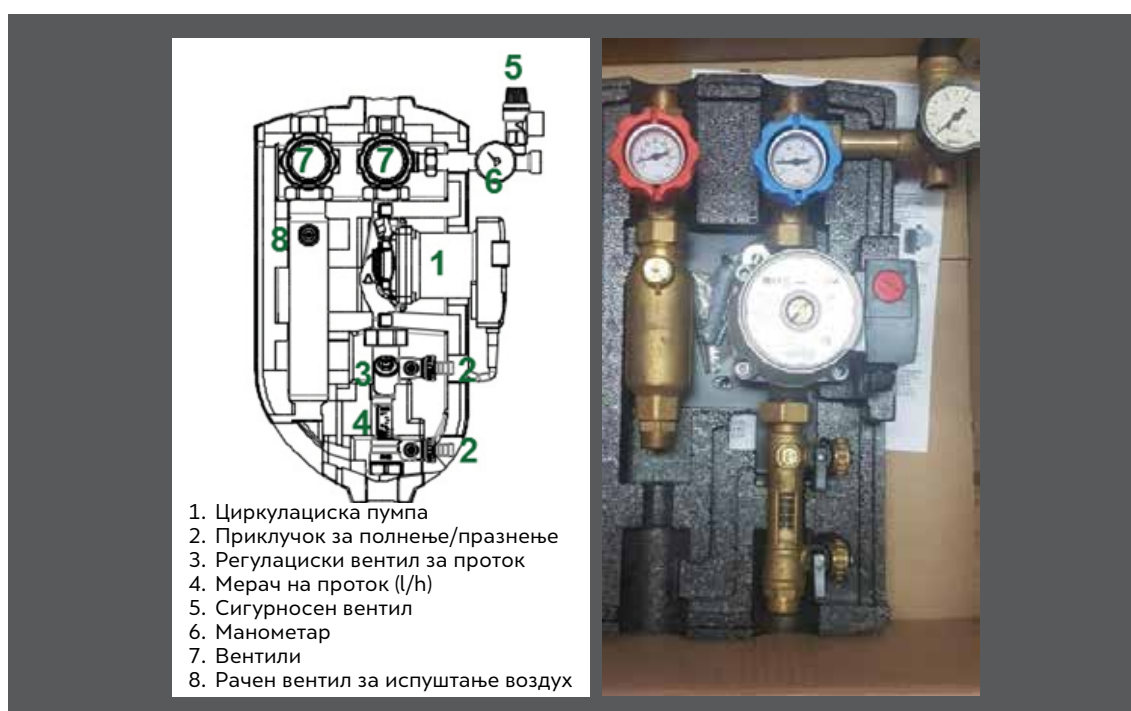
СЛИКА 11. Хидрауличен сет за сончеви колектори со циркулациска пумпа
